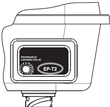
EP-T2 im Sichtfenster mit Bajonettsteckanschluss Gerät mit EP-T2 Anschlussplan siehe Kapitel 7.2.10 zur Funktion siehe Kapitel 11.4
