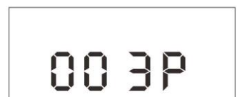
Abb. 23.6 Einstellung 3P Schmierzeit „Minuten“
