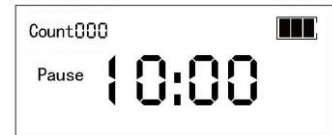
Abb. 23.2 Pausenzeit Display nach erstem Anschluss an die Spannung
