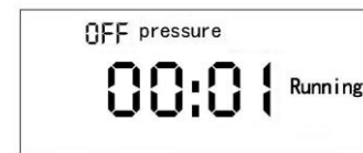
Abb. 24.2 Display zählt Pausenzeit 1P nach unten
