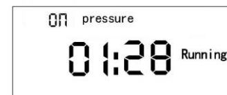
Abb. 24.3 Display for Schmierzeit 3P zählt aufwärts
