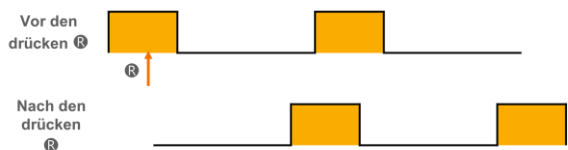
Abb. 24.5 Schmierzeit ändert sich durch drücken der \text{\textcircled{R}} Taste während der Schmierzeit
