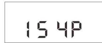
Abb. 24.1 Einstellung 4P Tieftemperatur
